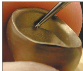
18. Controlar la superficie interna cuidadosamente y corregir los defectos
