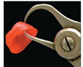
10. Comprobar el espesor - entre 0.3-0.4 mm - con un calibre y controlar los márgenes
